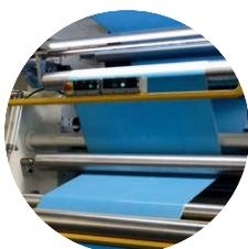
Le nostre rotative possono spalmare **coating barriera, lacche termosaldanti per carta, PET, PVC, lacche antifog** con la possibilità di applicare un ampio range di grammature di prodotti base solvente o acqua o alcol. Il coating consente di conferire ai materiali caratteristiche aggiuntive.
