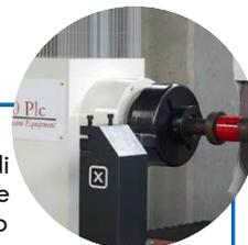
Forniamo anche il servizio di rettificazione di cilindri e maniche gommate: nel nostro reparto disponiamo infatti di una rettificazione "ROSSINI" a controllo elettronico per maniche e rulli rivestiti in gomma e/o tecnopolimeri. La nostra tecnologia garantisce tutte le fasi di lavorazione: profilo trapezoidale-conico-convesso, gradinatura, bombatura, intestatura, tornitura, rettificazione.
